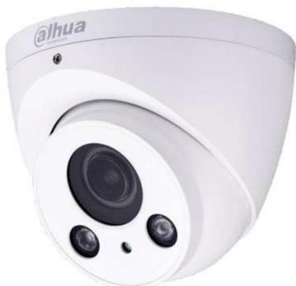
IR dome Eyeball IP H265 da esterno/interno IP67, sensore CMOS progressivo 1/2.7" progressive CMOS, risoluzione 5Mp con 15Fps, ICR auto, ottica motorizzata 2.7~13.5mm f1.6, luminosità 0.02Lux f1.6 (0 con Led ON), portata led IR fino a 50mt, 1 LAN 10/100Mbps, WDR (120db), 3DNR, slot per microSD card fino a 128 GB, alimentazione 12Vdc o PoE <9.5W
